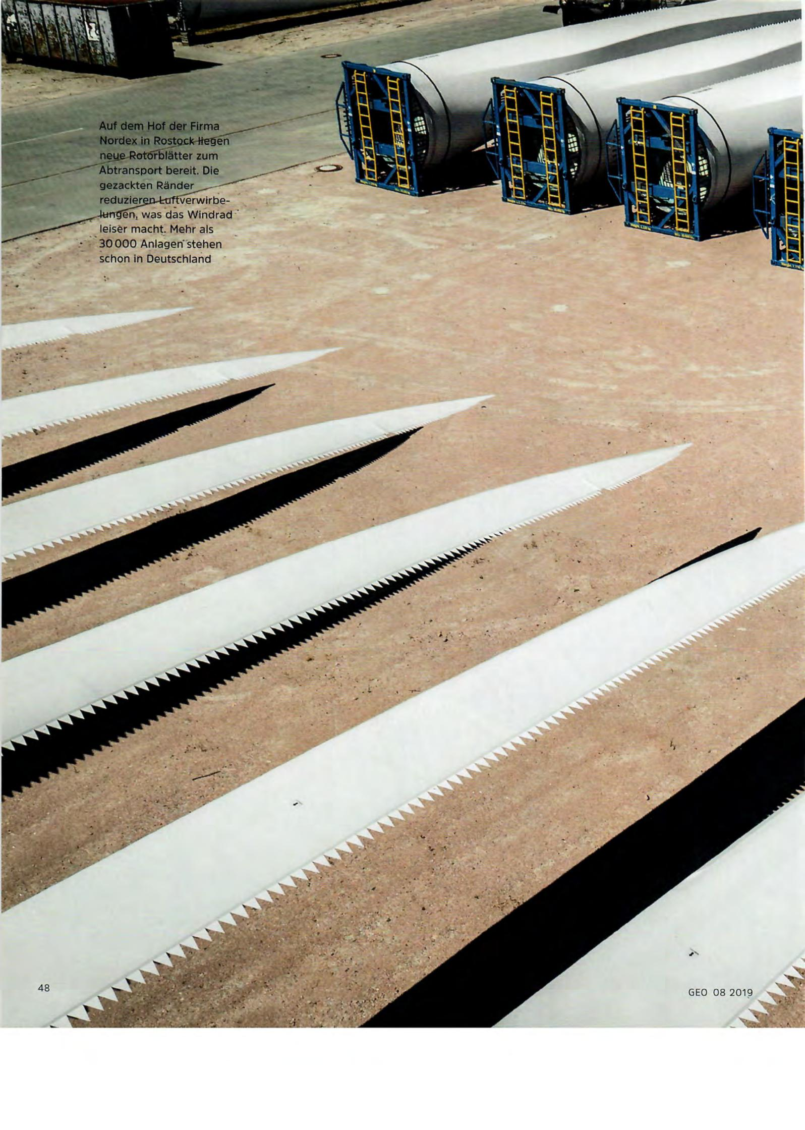
Auf dem Hof der Firma Nordex in Rostock liegen neue Rotorblätter zum Abtransport bereit. Die gezackten Ränder reduzieren Luftverwirbelungen, was das Windrad leiser macht. Mehr als 30 000 Anlagen stehen schon in Deutschland
