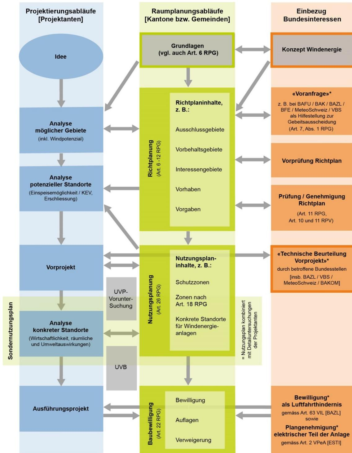
Abbildung 2: Planungs- bzw. Projektierungsabläufe und Einbezug der Bundesinteressen bei Windenergieanlagen (die Umrandungen in orange weisen darauf hin, dass die entsprechenden Elemente «technische Beurteilung Vorprojekt» ist 2018 neu sineingeführt worden;\* die Sterne weisen darauf hin, dass diese Elemente über den
